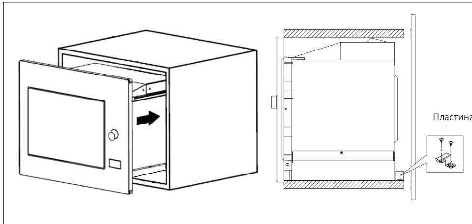
5. Відкрийте дверцята, закріпіть піч до шафи гвинтом, у монтажному отворі.
